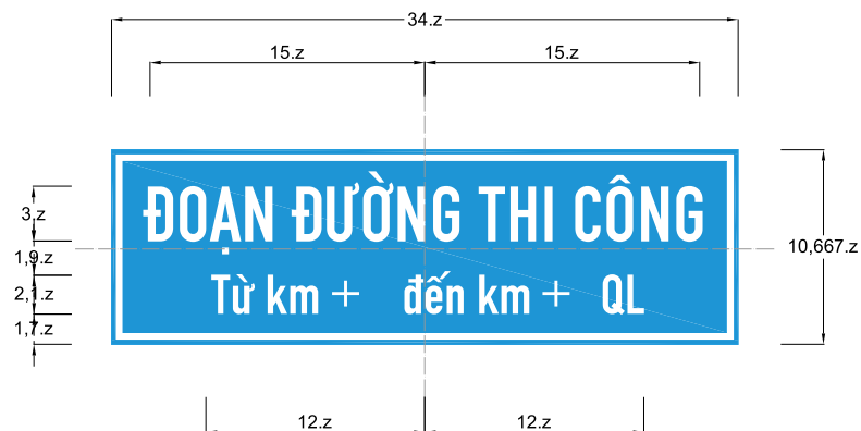
Biển số I.440 : Đường đang thi công
