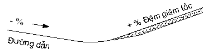
a) Đường cứu nạn bố trí đệm giảm tốc dốc lên
